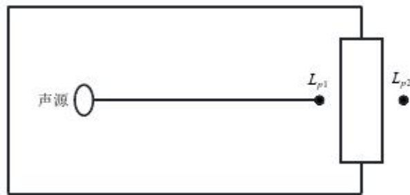
图 3 室内声源等效为室外声源图例
